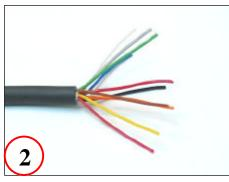
Spread apart wires, untwist pairs if necessary
